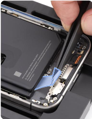
Le batterie di iPhone sono fissate utilizzando adesivi avanzati progettati per staccarsi quando vengono tirati in una direzione specifica, per consentire la sostituzione della batteria.
